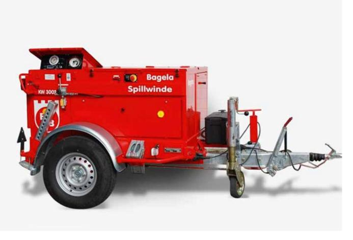
Die Bagela Spillwinde dieser Baureihe besticht durch ihre Zuverlässigkeit, Mobilität und dem geringen Platzbedarf. Der Antrieb der Winden erfolgt über ein stufenloses, hydrostatisches Getriebe, welches von einem Zweizylinder-Viertakt-Benzinmotor betrieben wird. Das gesamte Kraftpaket, einschliesslich der Armaturen, ist in einem schallisolierten und verschliessbaren Stahlblechgehäuse untergebracht. Die Zugkraft wird von einem seilschonenden Zweischeiben-Rillenspillsystem erzeugt.
